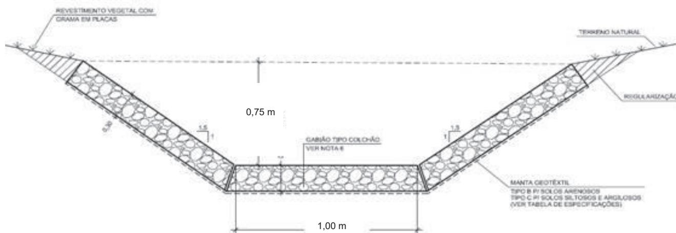
Ilustração 8.7 - Seção planejada para o canal trapezoidal.
