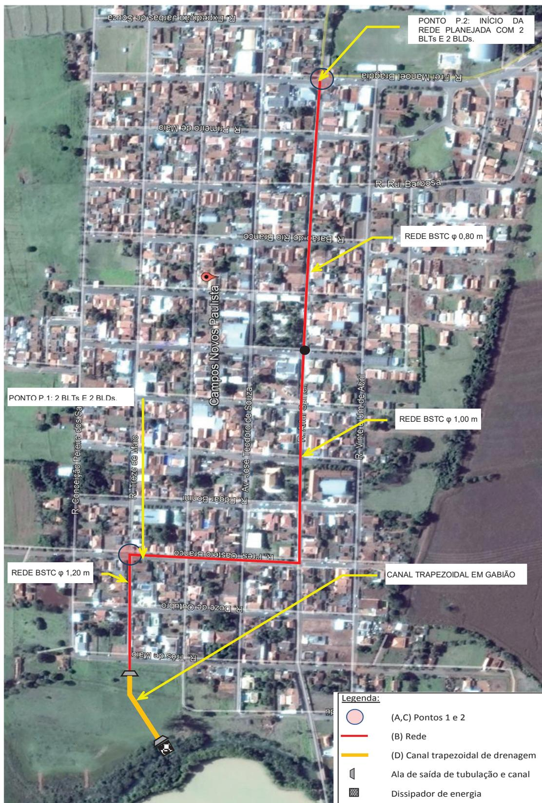
Ilustração 8.1 - Esquema da solução proposta para os Ponto 1 e 2.
